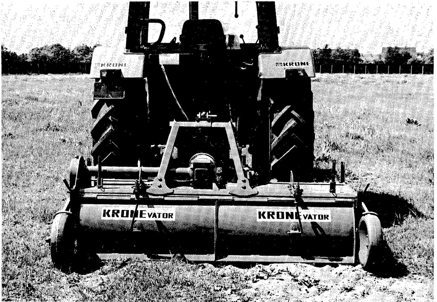
Die Unterlenkerzapfen lassen sich durch Vertauschen der Unterlenkeranschlüsse in verschiedene Höhen bringen, wenn man sie hierbei dreht. Unterläßt man das Drehen der Unterlenkeranschlüsse, wird mit diesem Tauschvorgang die Kategorie der Unterlenkerzapfen geändert.
