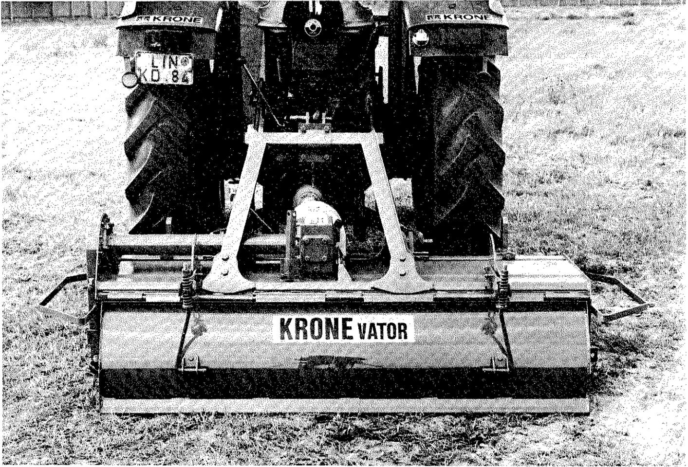
Die Unterlenkerzapfen lassen sich durch Vertauschen der Unterlenkeranschlüsse in verschiedene Höhen bringen, wenn man sie hierbei dreht. Unterläßt man das Drehen der Unterlenkeranschlüsse, wird mit diesem Tauschvorgang die Kategorie der Unterlenkerzapfen geändert.
