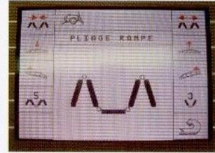
Display mit den hydraulischen Klappfunktionen zur sicheren Ausführung
